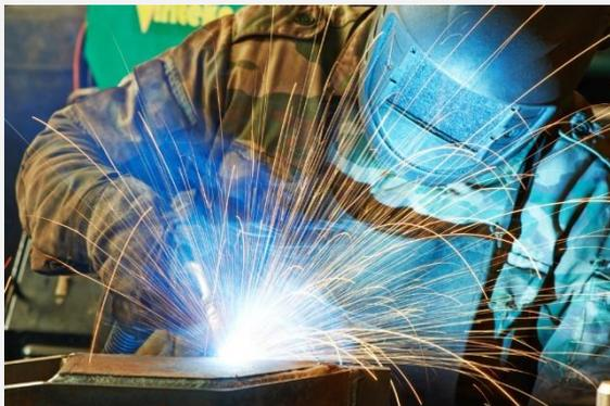
Bauteile und Baugruppen heften sowie Bleche und Profile aus Stahl im **Dickenbereich 2 mm – 10 mm** in verschiedenen Nahtarten und Schweißpositionen schweißen, einschließlich
